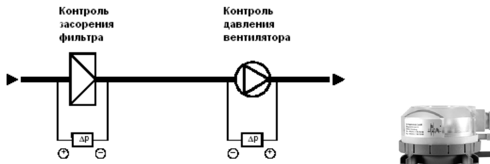
Рисунок 3. Внешний вид и примеры использования датчиков давления.
