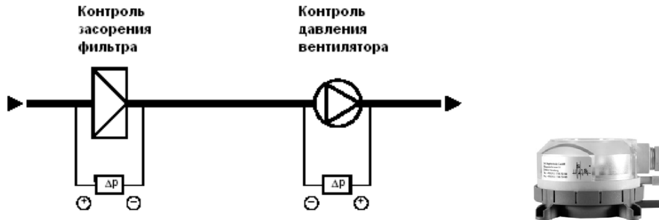
Внешний вид и примеры использования датчиков давления.
