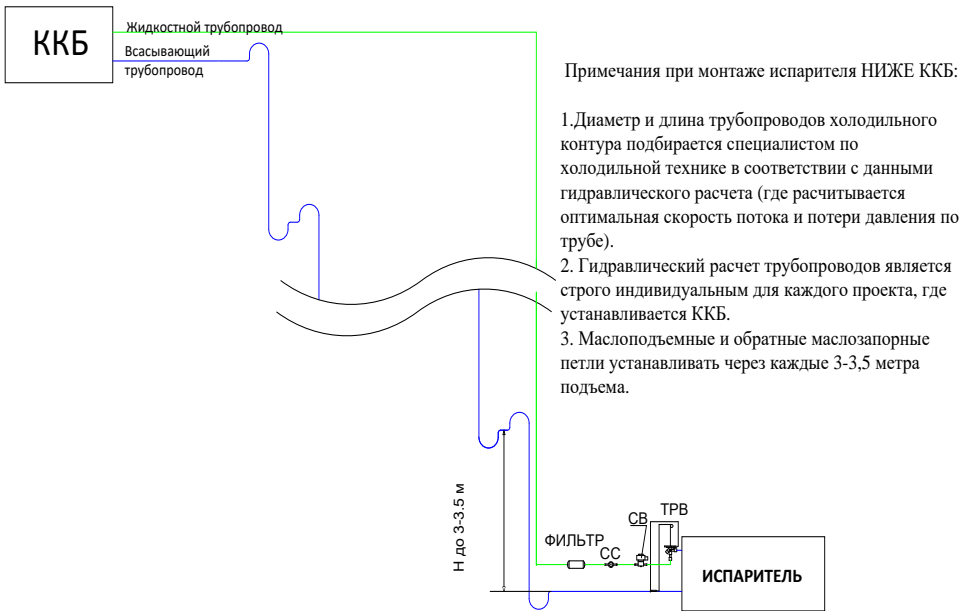
Рис.9.8. Рекомендации при монтаже испарителя ниже ККБ
