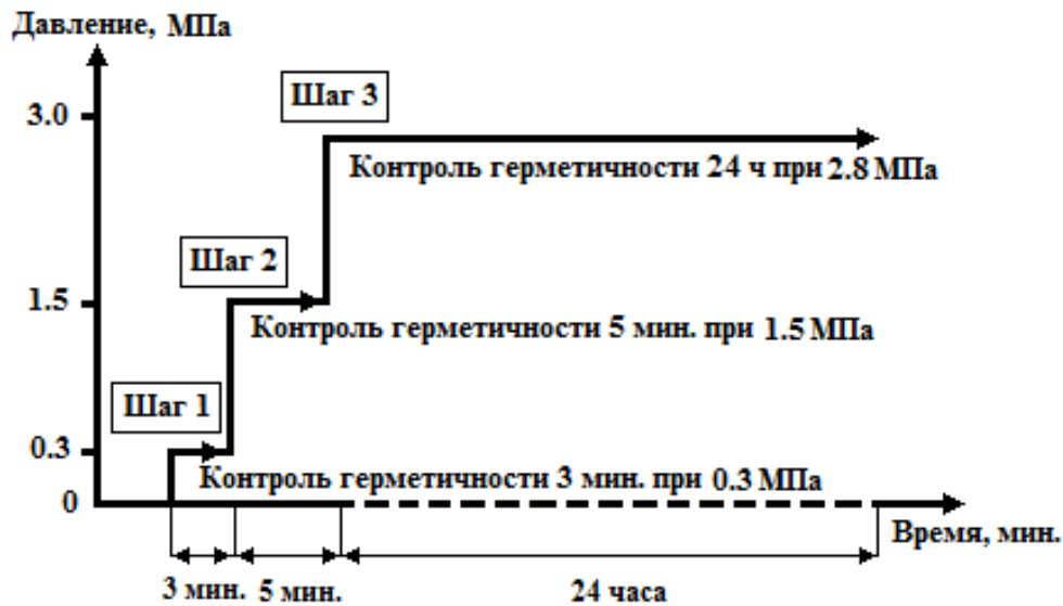
График проведения испытаний на герметичность
